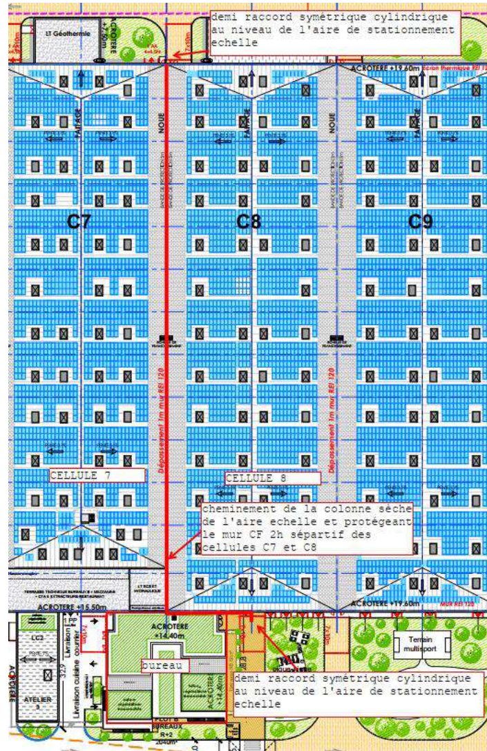
Figure 13 : Plan de l'installation de la colonne sèche
